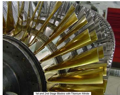
Figura 2.3.- Ejemplos de aplicaciones del titanio en la industria aeroespacial [10] y [11].
