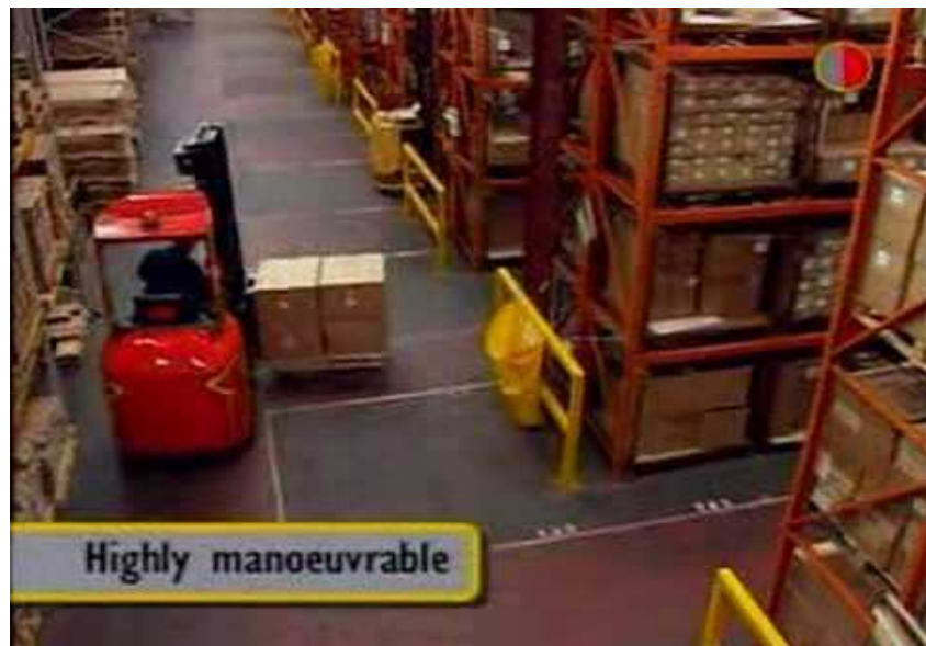
Figura 3.35: Carretilla operando en pasillo estrechos
