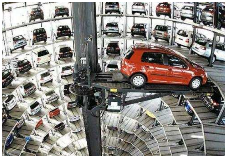
Figura 5. Robot de tipo cilíndrico [almacén de Volkswagen en Dresde (Alemania)].
