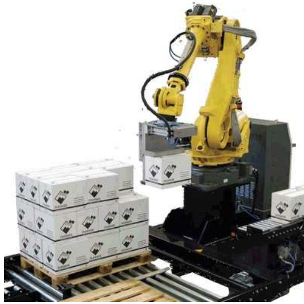
Figura 4. Robot esférico realizando una tarea de paletizado.
