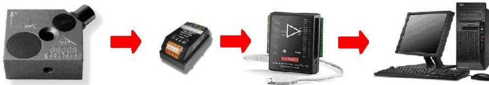
Figura 17. Esquema de la cadena de medida
