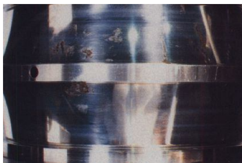
Figura 3.39.- Corrosión en el anillo interior de un rodamiento de rodillos esféricos a rótula, producida por la entrada de agua en el rodamiento.
