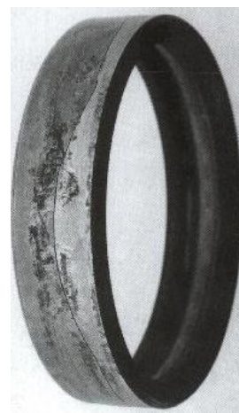
Figura 3.52.- Rotura longitudinal de un aro exterior de rodamiento rígido de bolas, con corrosión de contacto.
