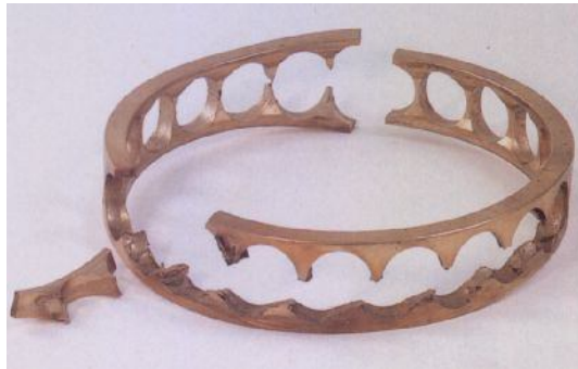
Figura 3.54.- Jaula deteriorada de un rodamiento de bolas debido a una pobre lubricación.
