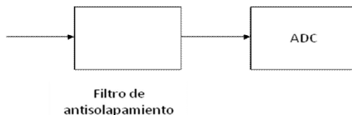
Figura 2.69.- Diagrama del filtro antisolapamiento previo a digitalización
