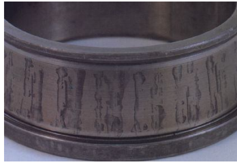
Figura 3.38.- Oxidación en el aro interior de un rodamiento cónico. La oxidación tiene un espaciado equivalente a la distancia entre elementos rodantes. La oxidación se ha producido por la presencia de agua en el lubricante.
