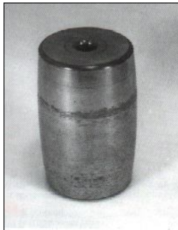
Figura 3.37 Fatiga superficial en forma de una banda rodeando el rodillo de un rodamiento de rodillos a rótula.
