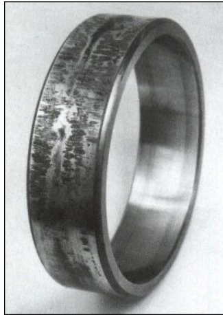
Figura 3.35.- Superficie exterior con adherencias en el aro exterior de un rodamiento de rodillos a rótula.
