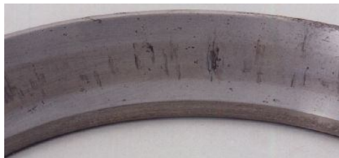
Figura 3.40.- Oxidación en el aro exterior de un rodamiento cónico. La oxidación tiene un espaciado equivalente a la distancia entre elementos rodantes. La oxidación se ha producido por la presencia de agua en el lubricante.
