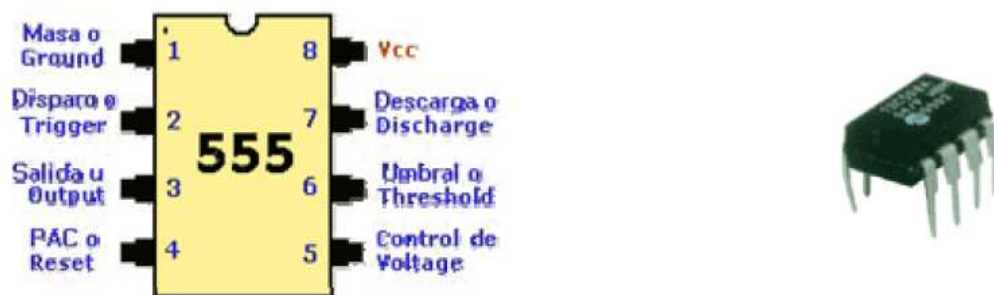
Figura 42: Pines y vista exterior del LM555
