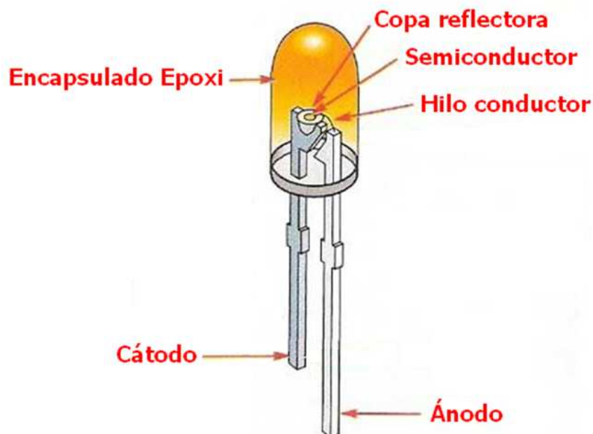
Figura 5: Partes de un diodo LED
