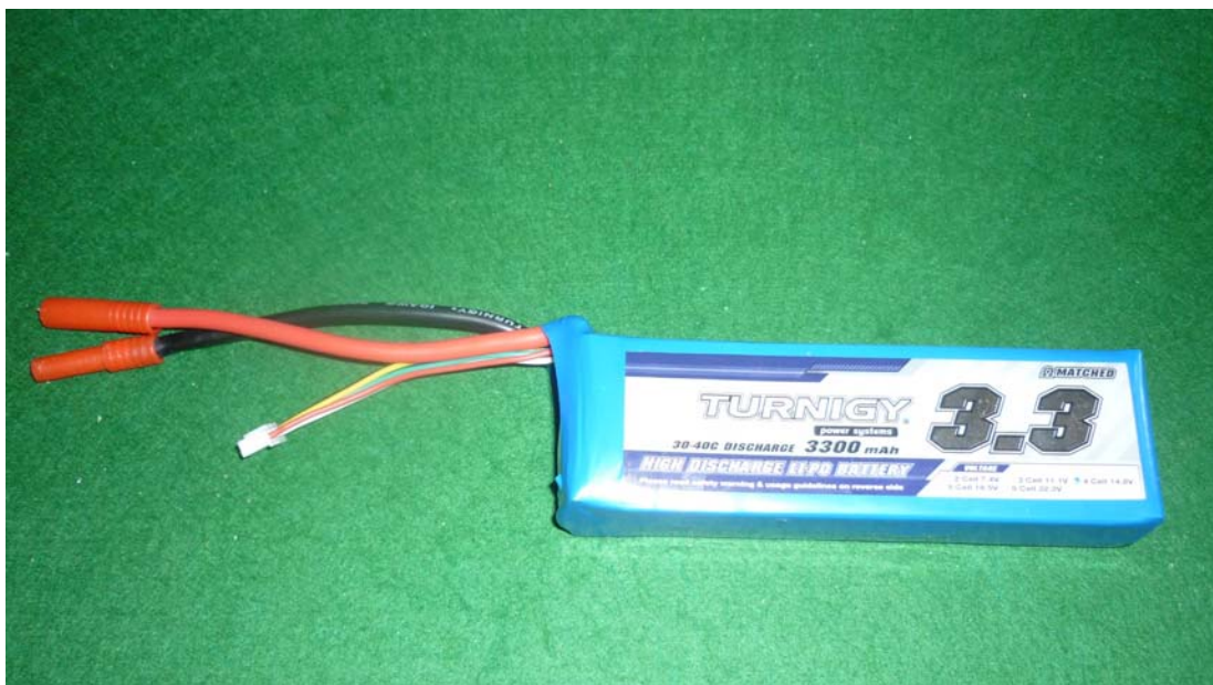
Figura 3.5. Batería de 14,7V y 3300mAh.
