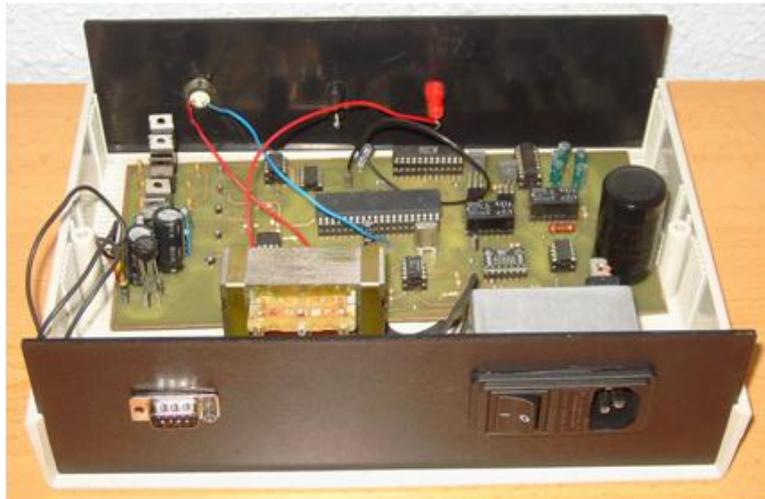
**Figura 44. Carcasa cara trasera abierta.**
