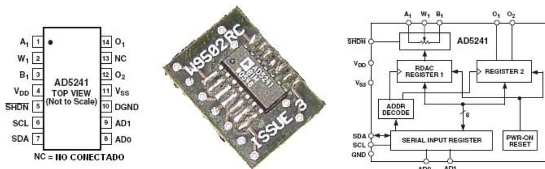
**Figura 38. Pineado, Foto y Diagrama de bloques del AD5241.**
