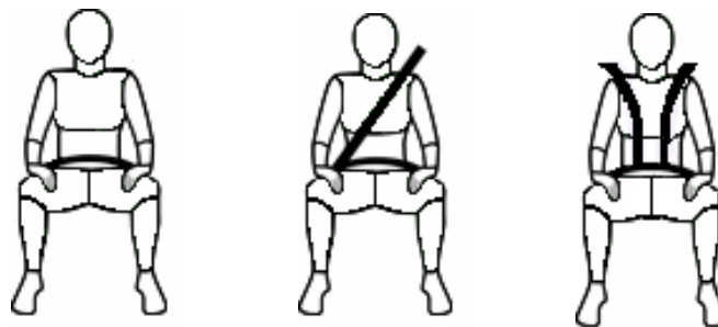
Figura 3-5: Esquema de diferentes tipos de cinturones de seguridad
