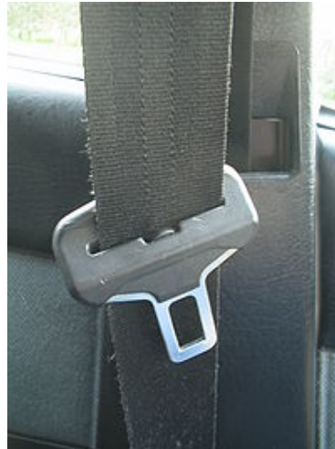
Figura 3-6: Hebilla de cinturón de seguridad de tres puntos colgando del pilar de un automóvil
