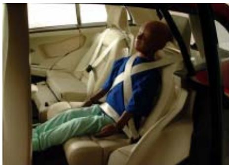
Figura 3-11: Imagen del cinturón en X (3+2)
