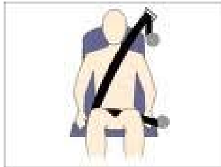
Figura 2-3: Esquema de cinturón de seguridad de tres puntos
