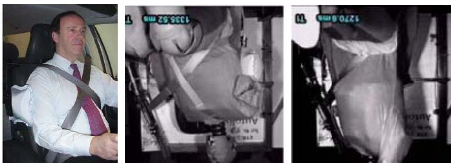
Figura 3-12: Imagen del cinturón 3+2 y de una prueba de vuelco con un cinturón 3+2 y otro con un cinturón de tres puntos convencional
