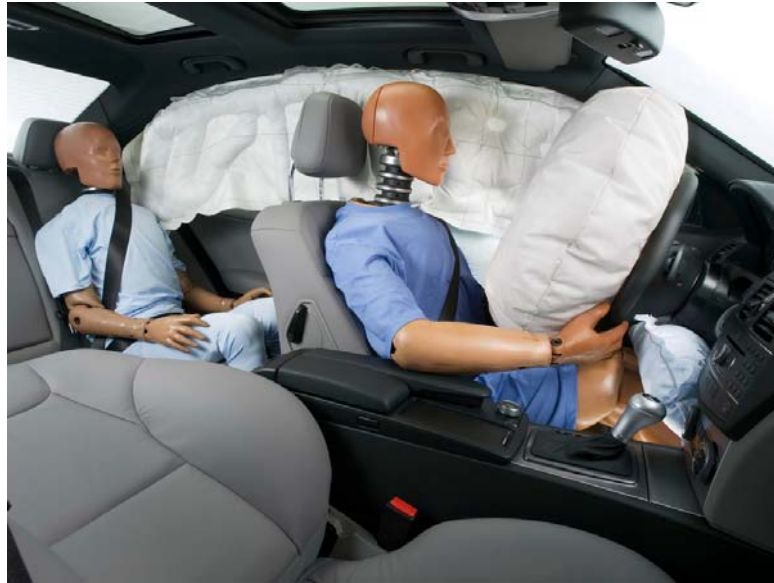
Figura 2-5: Habitáculo de un vehículo con airbags
