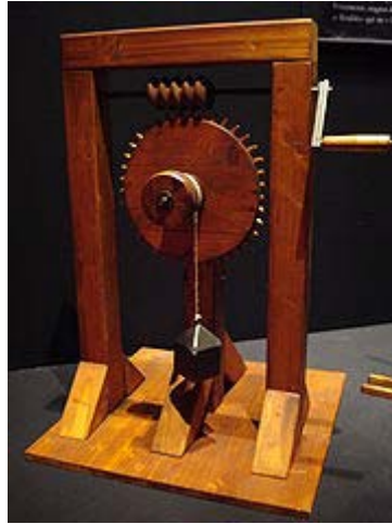
Ilustración 2: Engranaje helicoidal de Leonardo.
