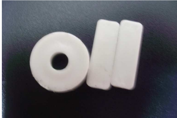
Figura 3.5. Pletinas de plástico para determinación de la altura relativa entre el imán y el superconductor.
