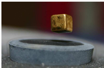
Figura 2.5. Imán levitando sobre superconductor en posición de equilibrio estable.
