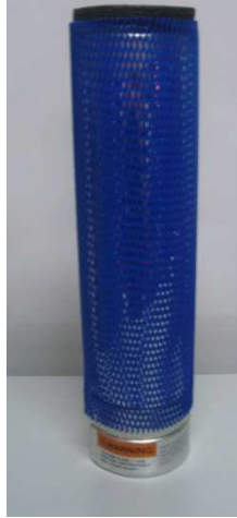
Figura 3.3. Vaso Dewar empleado en el experimento.
