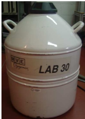
Figura 3.2. Tanque secundario de nitrógeno líquido de capacidad 32 litros.
