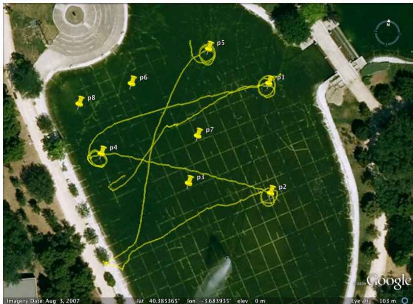
Figura 5.21: El barco con control ir a un punto .
