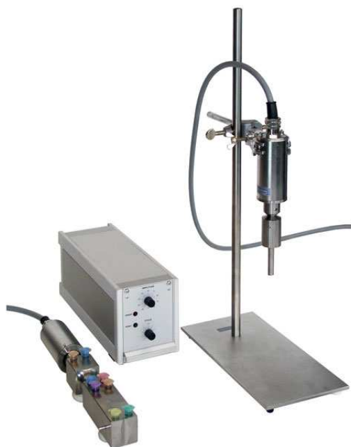
Figura 2.2: Generador de ultrasonidos con sonotrodo.
