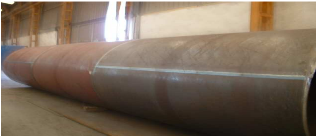
Figura 55: Tubería en Virolas
