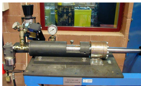
Fig. 6 – Detalle del cañón de gas
