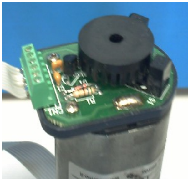
Ilustración 7.1.3.1.3: Encoder EB50 de Bernio acoplado al motor.
