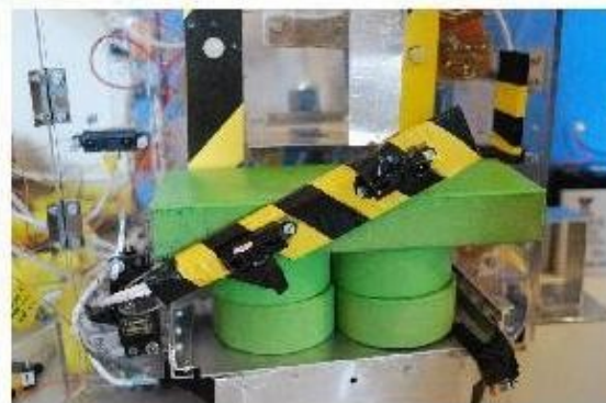
7°- Tras chocar contra el área de construcción, se levanta la barrera a 45° y se deja caer el dintel.
