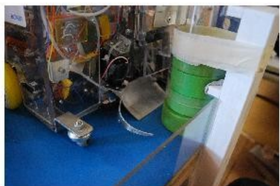
6º- Pala ancha totalmente abierta, los elementos columna caen al terreno.
