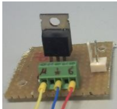
Ilustración 5.4.1: Interruptor para el motor asociado a la cinta elevadora.
