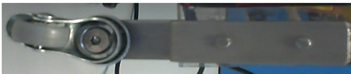
Ilustración 4.2.1.2.1: Rueda loca lateral con su estructura de acero.
