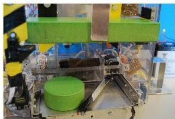
2º- La pala inferior arrastra la columna al lado derecho de la bandeja y vuelve a su posición inicial.
