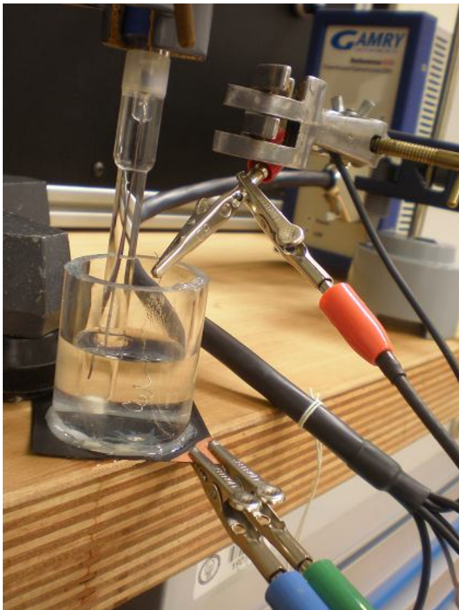
Figura 21: Fotografía de la probeta, con todos los cables conectados.
