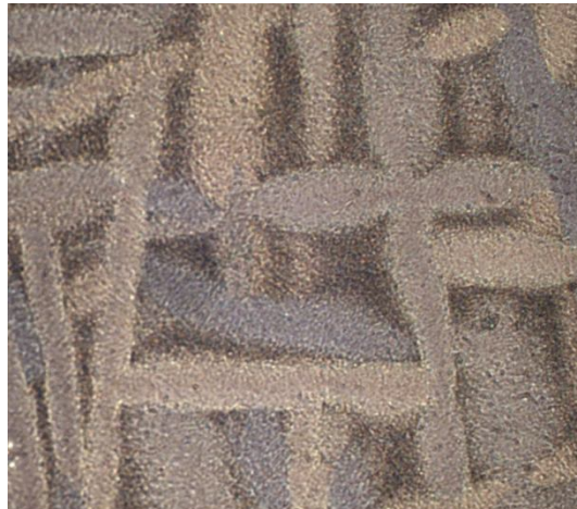
Figura 37: Imagen del Ti + Y_2O_3 al microscopio.
