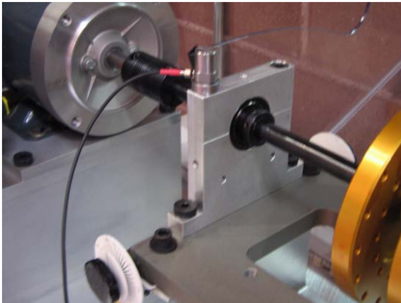
Colocación del acelerómetro en el rodamiento de ensayo.
