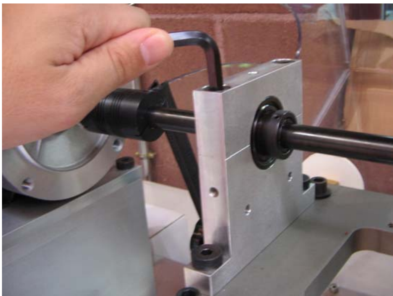
Aflojado de los tornillos superiores.
