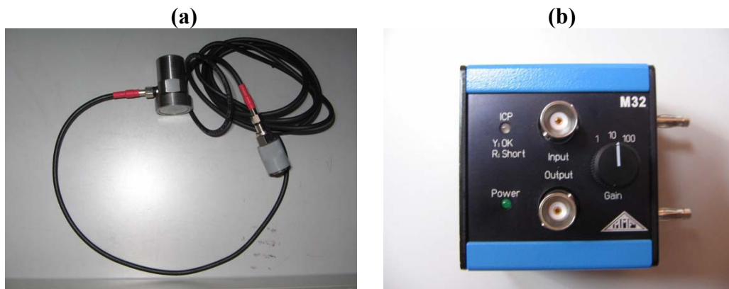
Figura 3.3 Acelerómetro (a) y amplificador (b) con la ganancia en la posición x10.
