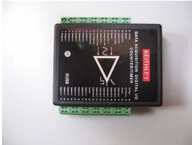
Figura 3.4 Tarjeta de adquisición de datos.
