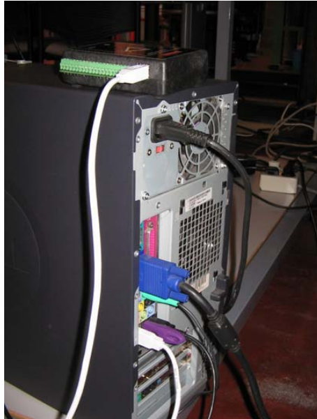
Conexión de la tarjeta de adquisición al ordenador.
