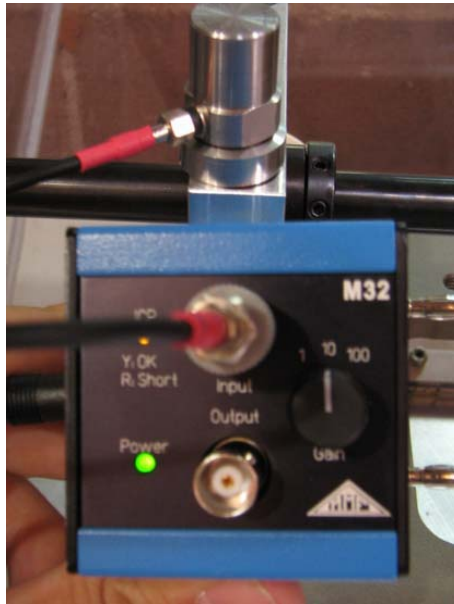
Conexión del acelerómetro al amplificador.
