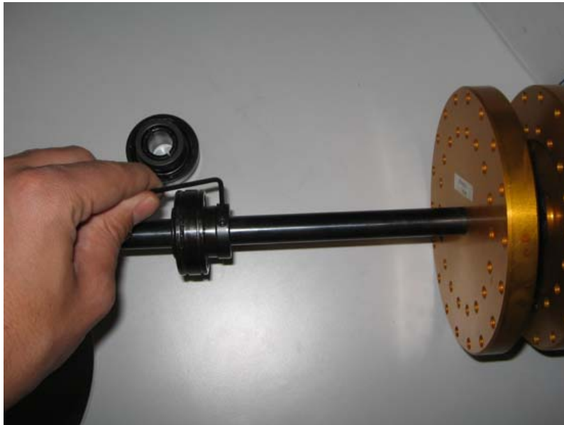
Retirada del rodamiento del ensayo y colocación de otro distinto.
