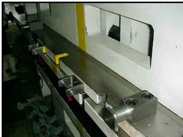
Fig. 70: Elementos de amarre y transporte de un Troquel.
