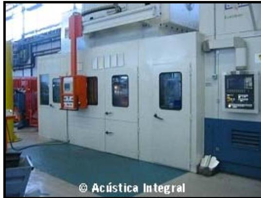
Fig. 53: Ejemplo de Cerramiento Acústico de Máquina. (Fuente: Acústica Integral S.A.)
