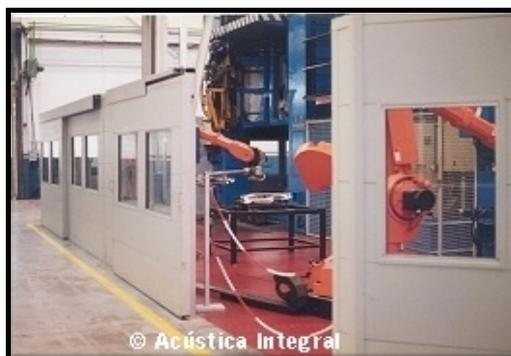
**Fig. 51: Ejemplo de Pantalla Acústica en Zona de Producción.**
