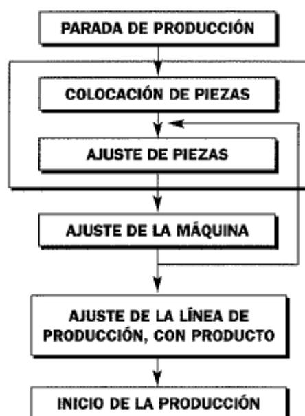
Fig. 74: *Proceso General de Ajustes en un Cambio de Útiles.*
