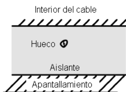
a) Huecos en el interior del aislamiento del cable
