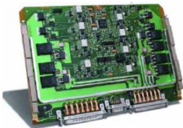
Figura 51. SSPC del fabricante DDC
