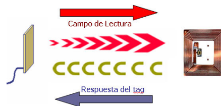
Fig. 9: Funcionamiento de un sistema RFID
