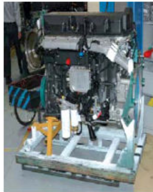
Fig. 25: Motor apoyado en Brackets
