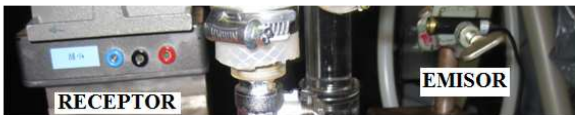
Figura 7.15: Receptor y emisor del sistema de detección de partículas
