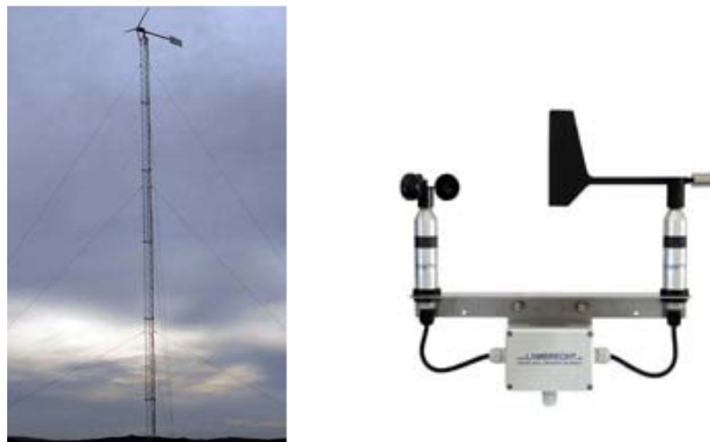
Figura 2.8. Estación meteorológica y sistema anemómetro-veleta.
