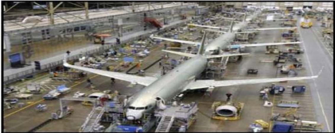
Figura 5.16. Proceso de Ensamblaje de aviones Boeing, Flujo Continuo.
