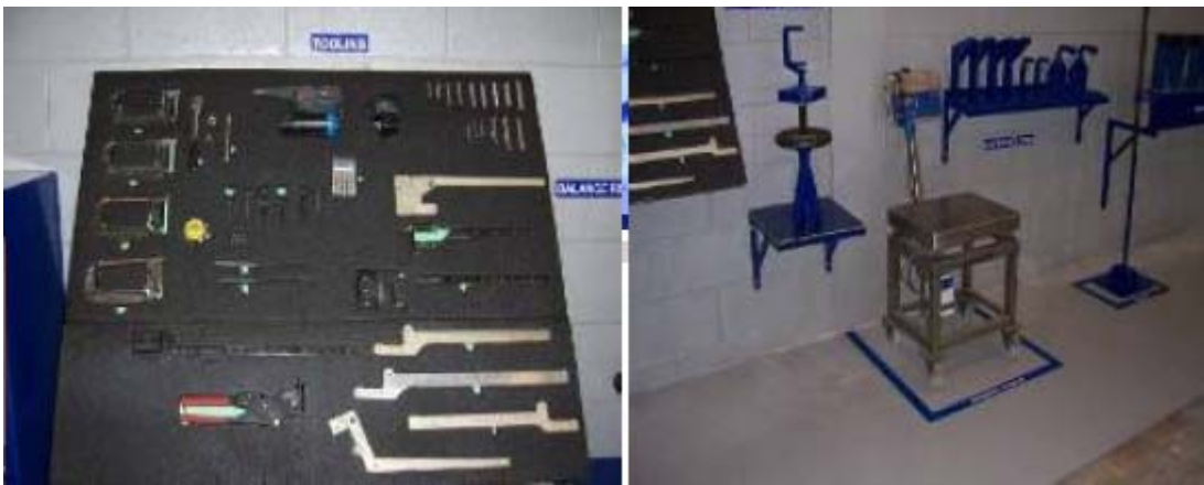
Figura 5.15. Ejemplos de Herramientas en Punto de Utilización. Fuente: Shannon Aerospace
