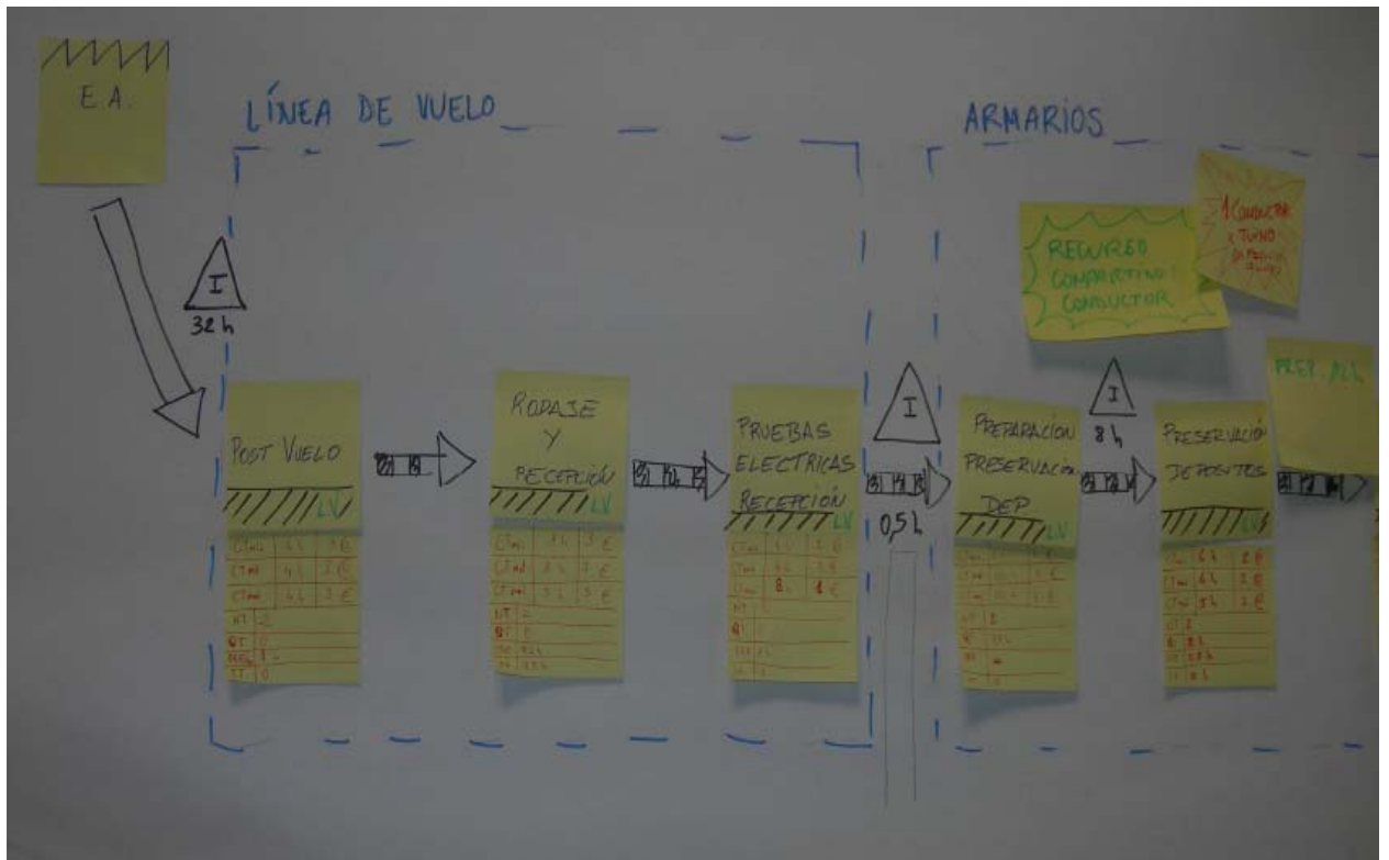
Figura 5.3 Imagen real del VSM de una actividad del Programa de MRO del Airbus A330. Fuente: Sisteplant
