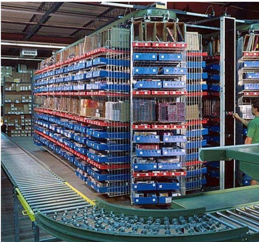
Figura 7.4. Ejemplo de Carrusel Horizontal, como apoyo a las actividades de MRO. Fuente: Diamond Phoenix
