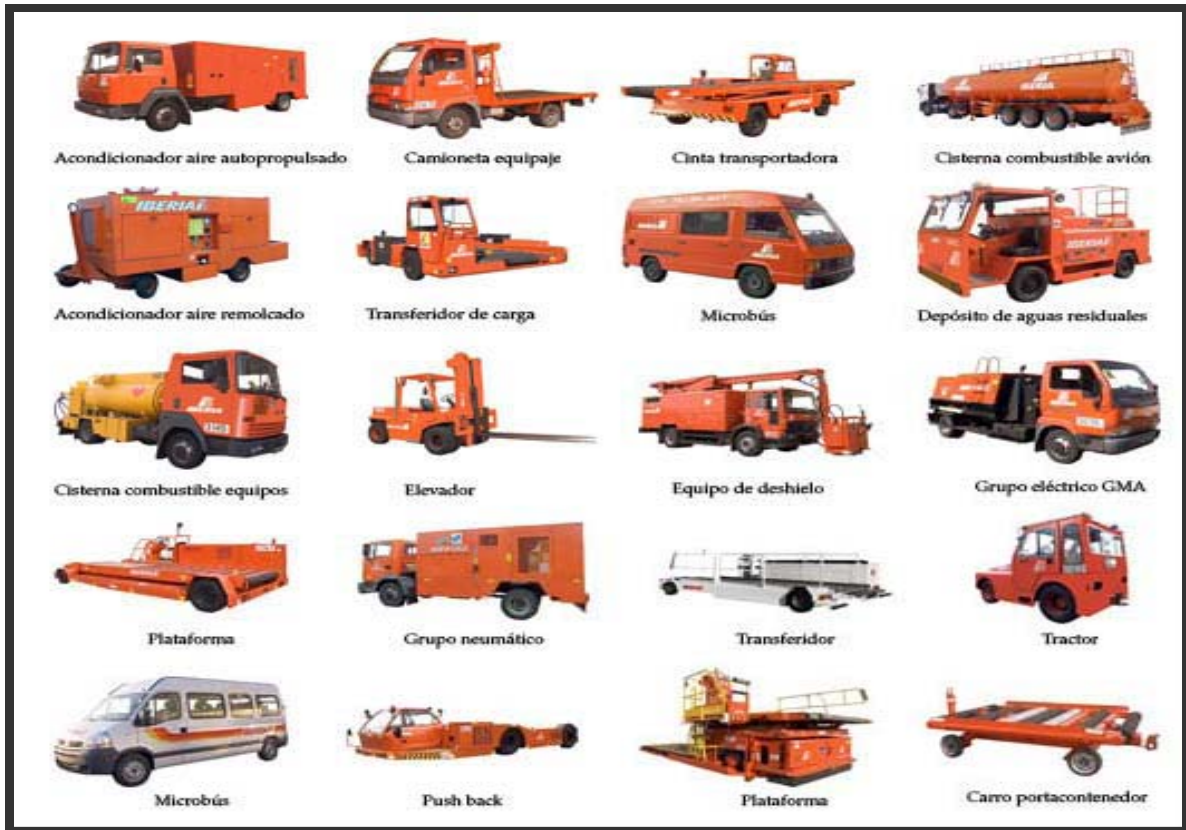
Imagen 5.1: esta imagen muestra la apariencia de los equipos móviles que se emplean para dar los servicios de Handling a los aviones en el aeropuerto de Madrid-Barajas.
