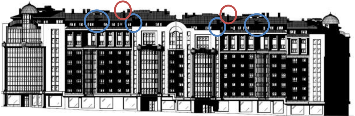
Imagen 7.6: Alzado edificio con situación de chimeneas
