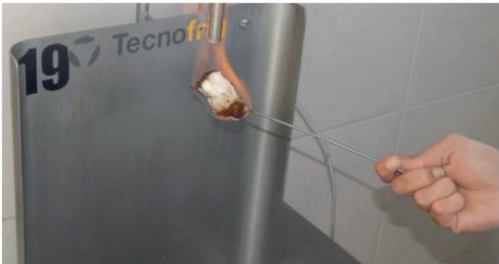
Figura 2: Flameado de grifo con alcohol
