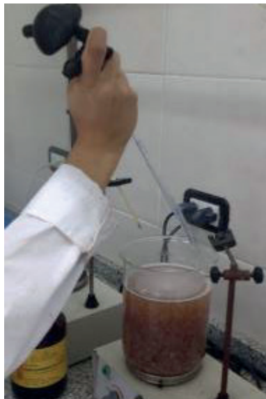
Figura 15: Colocación sobre platina térmica y agregado de Ácido Clorhídrico
