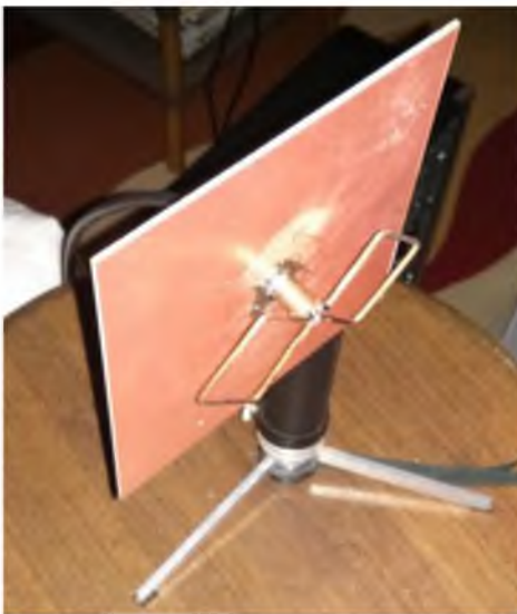
Fig 3.4.2.2- Antena Biquad fabricada.
