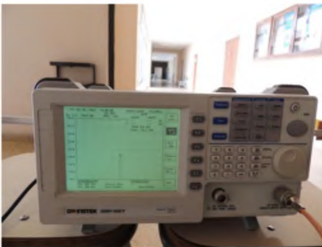
Fig 4.5.1.4 – Señal recibida, medición indoor 33 m. Potencia de salida 10 dBm. Frecuencia 2.4GHz
