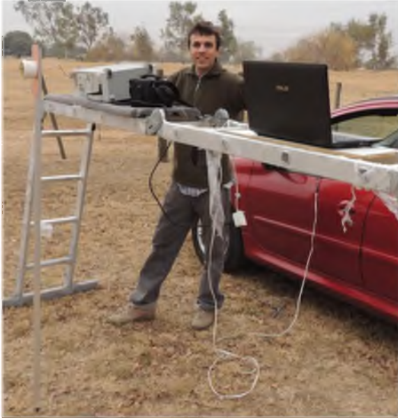
Fig 4.5.2.2 – Montaje de equipo receptor, enlace outdoor 600 m.
