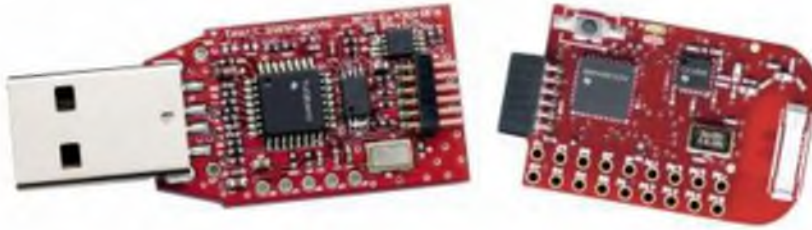
Fig 3.2.1- Kit de desarrollo Texas instruments, izquierda: emulador USB, derecha: target.
