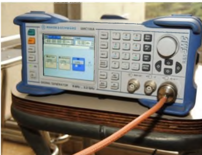
Fig 4.5.1.3 – Señal emitida, medición indoor 33 m. Potencia de salida 10 dBm. Frecuencia 2.4 GHz.
