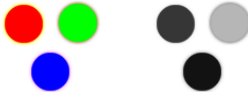
Figura 29 - Imagen RGB y componente de luminancia de dicha imagen
