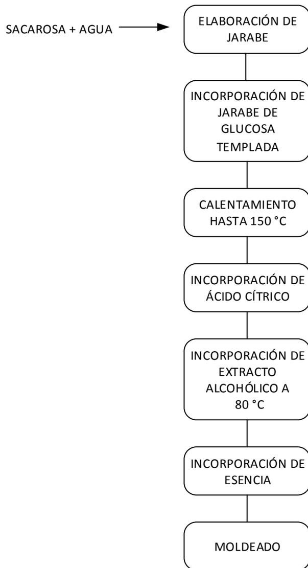
Figura 5. Diagrama de flujo de elaboración del caramelo duro
