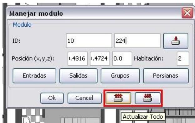
*Ilustración 43: Opciones de actualización y reprogramación masiva de un módulo*
