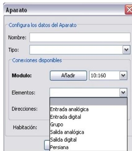
*Ilustración 27: Ventana de adición de aparatos con los elementos disponibles de un módulo*
