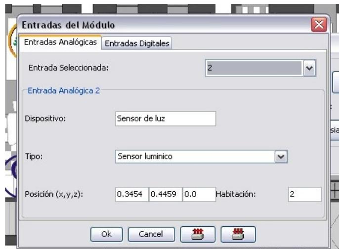
*Ilustración 45: Configuración de las entradas analógicas de un módulo*
