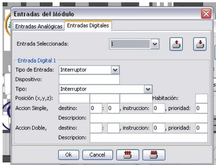
*Ilustración 46: Configuración de las entradas digitales de un módulo*
