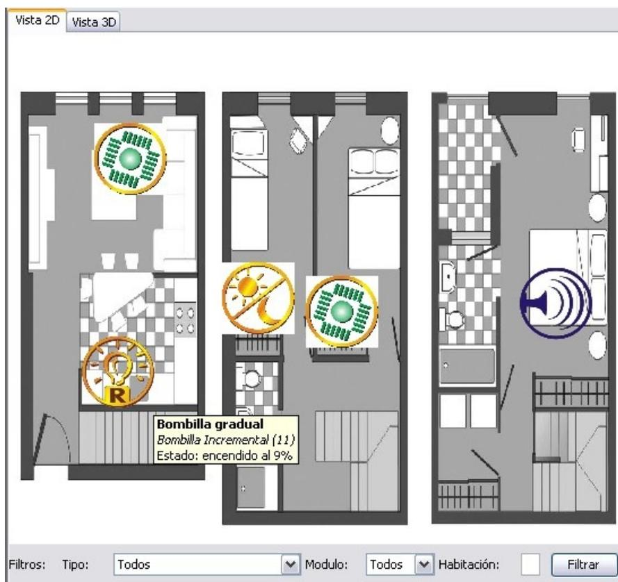
*Ilustración 34: Mapa de Dispositivos mostrando un 'tooltip' con información de un aparato*
