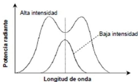
Figura n°7: Perfiles de emisión en lámparas de cátodo hueco funcionando con altas y bajas intensidades de corriente.
