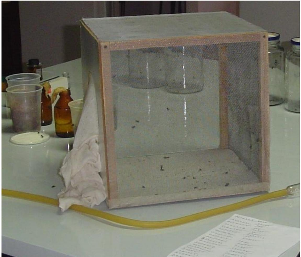
**Figura 13.** Caja entomológica para los bioensayos
