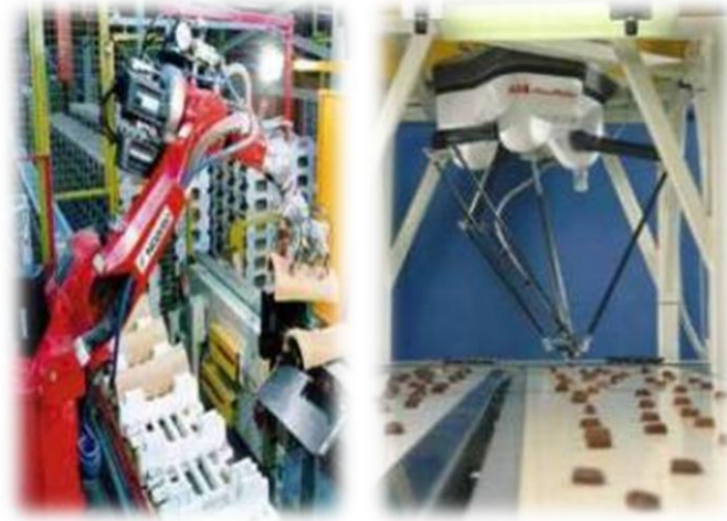
Figura II.13: Robot puliendo (izquierda). Robot desbarbando piezas (derecha)
