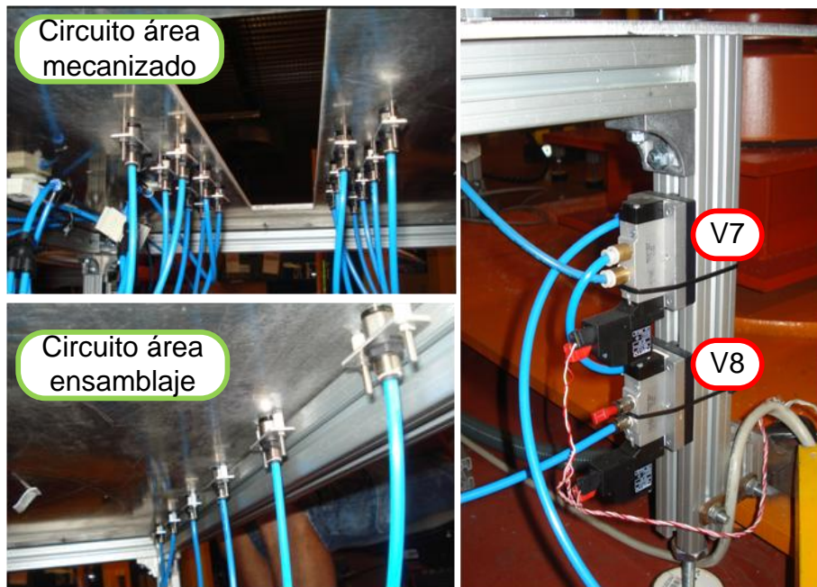
Figura VI.12: Puesta en marcha de circuito neumático del área de trabajo.
