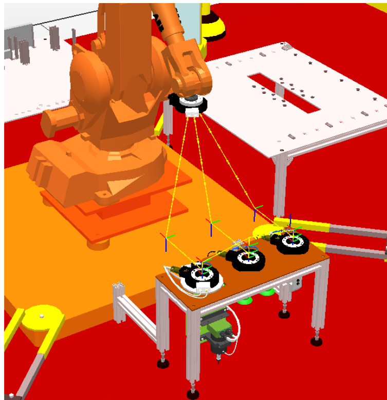
Figura V.48: Trayectorias del cambio de herramienta.
