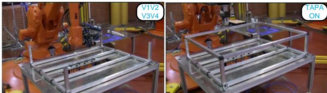
Figura VI.18: Etapa3 del proceso de ensamblado del bastidor.
