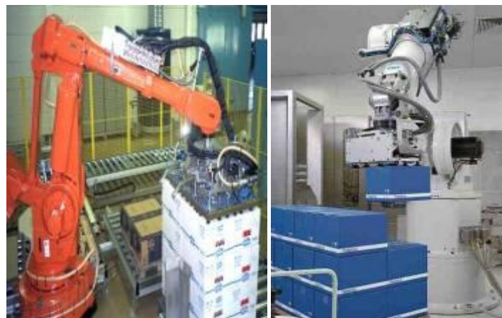
Figura II.10: Uso de robot en labores de paletización
