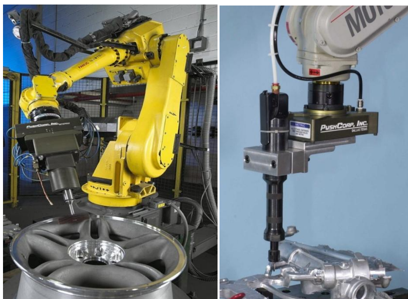
Figura II.28: Desbarbado de una llanta para automóvil (izquierda) y desbarbado de cremalleras de aluminio y alojamiento para piñones (derecha)
