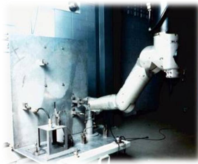
Figura II.16: Inspección de los tubos del generador de vapor en un reactor nuclear
