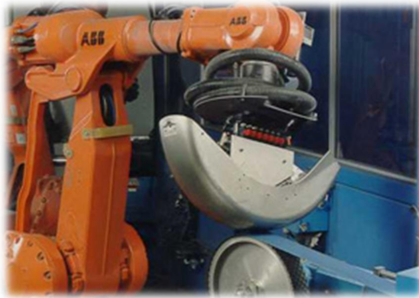
Figura II.30: Lijado del guardabarros de una moto
