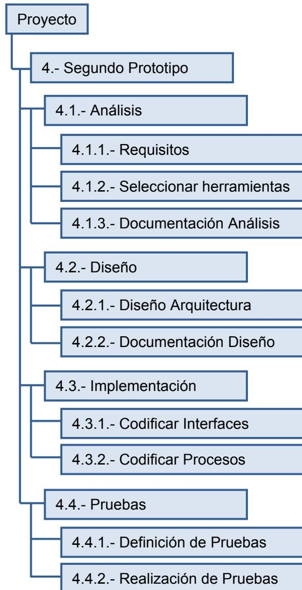
**Figura 9. Proceso WBS – Segundo Prototipo**
