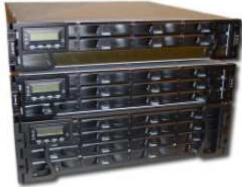
**ANÁLISIS DE IMAGENES:** esta unidad procesa en tiempo real el video y activa las alarmas y eventos previamente configurados. Tiene un procesador sobre el cual se ejecuta un software (Visiowave) que contiene todas las funciones de procesamiento de imágenes. Se pueden instalar otros paquetes de software si fuera necesario.
