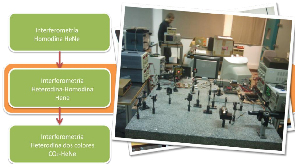
FIGURA IV-1. MONTAJES INTERFEROMÉTRICOS EMPLEADOS EN EL PROYECTO. INTERFEROMETRÍA HETERODINA-HOMODINA
