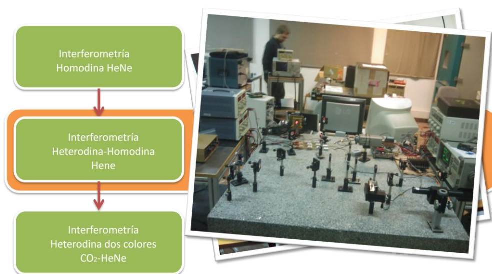
FIGURA III-1. MONTAJES INTERFEROMÉTRICOS EMPLEADOS EN EL PROYECTO. INTERFEROMETRÍA HETERODINA-HOMODINA
