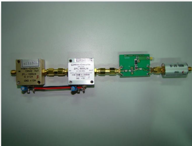
FIGURA IV-8. CADENA DE AMPLIFICACIÓN FORMADA POR DOS AMPLIFICADORES INTEGRADOS DE RF DE MINICIRCUITS Y UN AMPLIFICADOR MONOLÍTICO DE RF DE MINICIRCUITS
