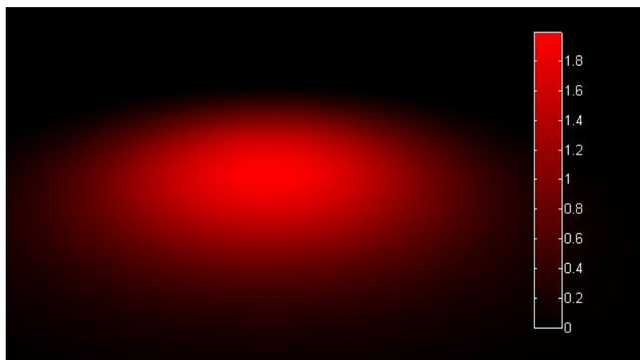
FIGURA II-19. INTENSIDAD ÓPTICA DEL FRENT DE ONDA INTERFERENCIAL PARA DISTANCIAS RECORRIDAS POR LOS HACES z_1=z_0 Y z_2=z_0 .
