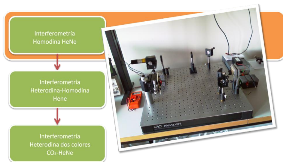
FIGURA II-16. MONTAJES INTERFEROMÉTRICOS EMPLEADOS EN EL PROYECTO. INTERFEROMETRÍA HOMODINA
