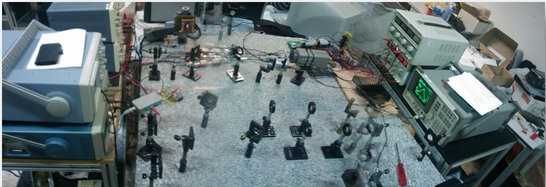
FIGURA III-4. VISTA PANORÁMICA DEL INTERFERÓMETRO HOMODINO-HETERODINO EN FUNCIONAMIENTO
