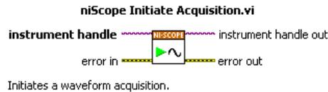
**Figura 6.14: Bloque para iniciar la adquisición.**
