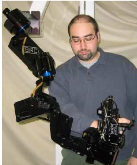
Figura 1.21: Sarcos Master Arm , exoesqueleto con actuación hidráulica y 7 GdL.
