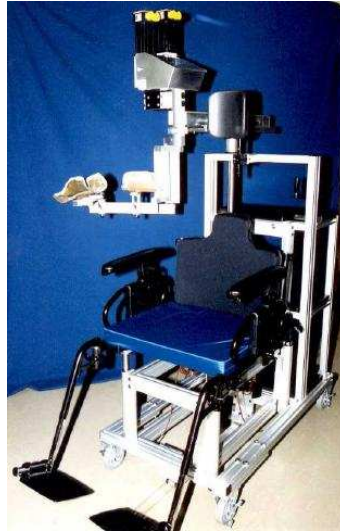
Figura 1.20: KINARM: exoesqueleto de brazo y antebrazo para realizar estudios de movimiento.
