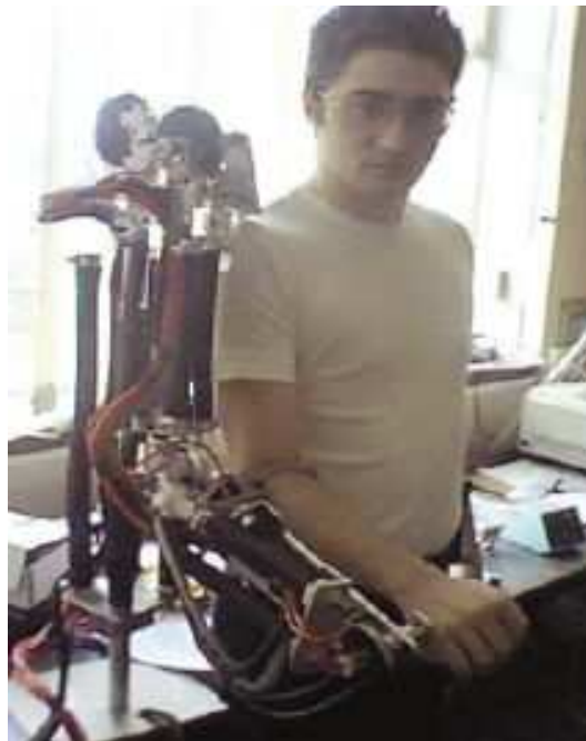
Figura 1.12: Prototipo exoesquelético de 7 GdL enfocado a la rehabilitación del miembro superior que utiliza actuación neumática (pMA), [58].
