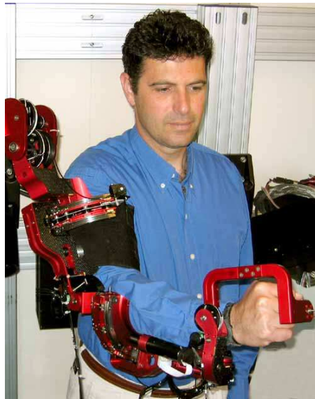
Figura 1.11: Sistema exoesquelético de Rosen de 7 GdL, para personas con discapacidad motora basado en señales mioeléctricas, [57].
