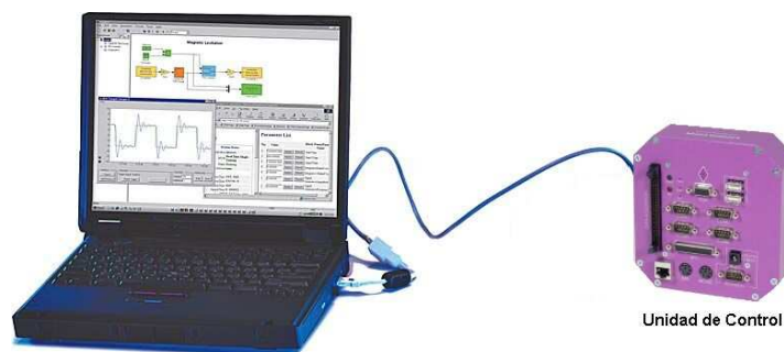
Figura 3.2: Esquema de comunicación entre la interfaz de usuario para el control de la plataforma y la unidad de control.
