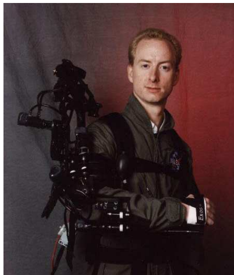
Figura 1.9: “ Exoskeleton Force ArmMaster ”, dispositivo robótico de miembro superior para aplicaciones de telemanipulación.
