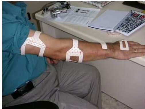
Figura 2.14: Soportes fabricados en termoplástico para soportar el exoesqueleto sobre el miembro superior.
