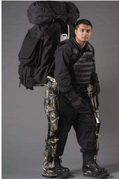
Figura 1.5: “ Bleex Exoskeleton ”, exoesqueleto robótico para aumentar la carga que puede levantar una persona y la velocidad que puede alcanzar. Destinado a aplicaciones militares.
