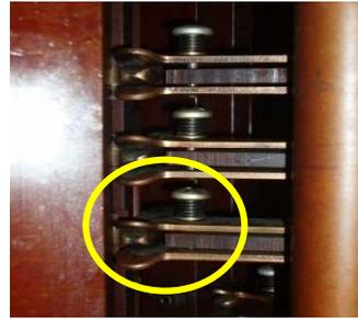
**Figura 4.24. Muelles de los contactos móviles del selector sin la tensión adecuada**
