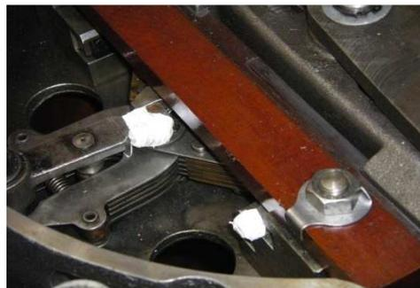
Figura 4.29. Amortiguación en la leva y en el sistema de enclavamiento.
