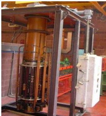
Figura 4.1. Cambiador de tomas en carga utilizado en los ensayos
