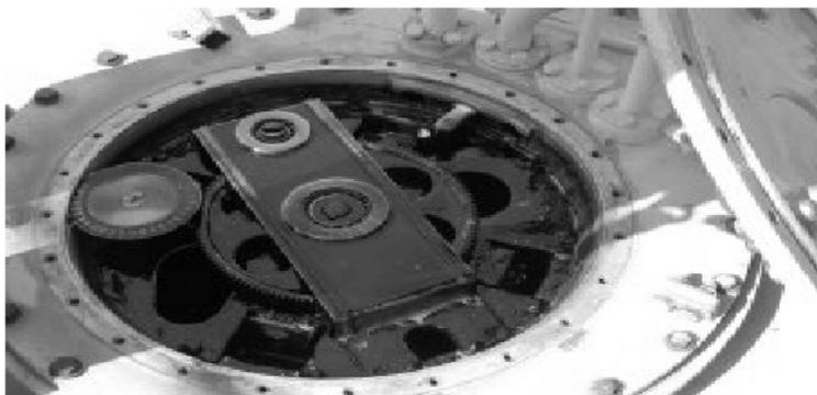
**Figura 2.15. Capa de carbón cubriendo toda la superficie de la cabeza del regulador**
