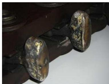
**Figura 4.27. Contactos del selector erosionados debido a la acción del arco eléctrico**
