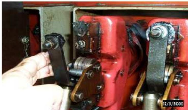
**Figura 2.14. Contactos colapsados debido a mal sincronismo**
