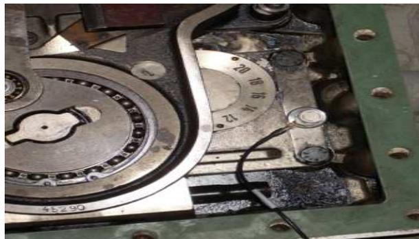
Figura 4.6. Acelerómetro. en la pletina del conmutador aledaña a las cruces de malta.
