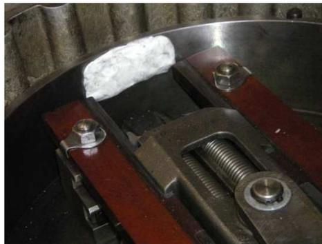
Figura 4.28. Amortiguación al final del recorrido del carro superior.
