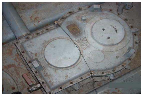
**Figura 4.4. Acelerómetro en la tapa del regulador**
