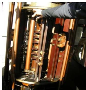
Figura 4.2. Detalle del selector, mostrando la barra rota de la toma número 5
