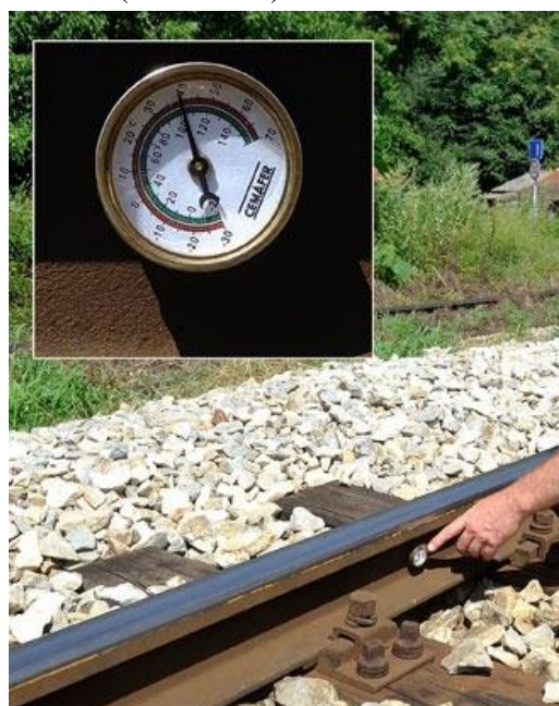
Slika 6 - Standardno merenje temperature (merna lokacija Topčider, juli 2017. godine)
