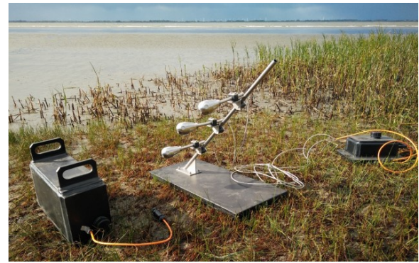
Abbildung 1. Gestell mit den drei Sensoren (Mitte) des Watt-SST mit austauschbarem Akku (links) und Messrechner (rechts).
