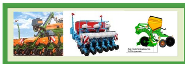
Abbildung 1: Pneumatischer Mikrogranulatstreuer (links) installiert an einer Einzelkornsämaschine des Herstellers Amazone (WILHELM, 2015, S. 38 f); mit mechanischen Antrieb (mitte) des Herstellers Monosem (MONOSEM, 2013). Schematische Darstellung der Applikation von Mikrogranulaten am Einzelkornsächar (rechts verändert nach PLESSER, 2016)
