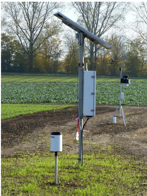
Abb. 3: Sensorensysteme zur kontinuierlichen Erfassung von Wetterdaten und Bodenfeuchtezuständen in den Feldversuchen
