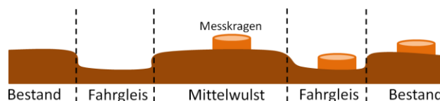
Abbildung 1: Schematische Darstellung eines Fahrspurprofils mit Einteilung in Straten und zugehörigen Messkammern.
