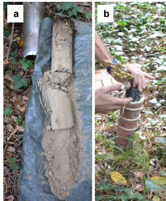
Abbildung 2: Installation des Gasprobennahmesystem im Feld. (a) der Bodenkernelement gewonnen mit dem Murach-Bohrer; (b) Installation des Gassamplers in das Bohrloch.
