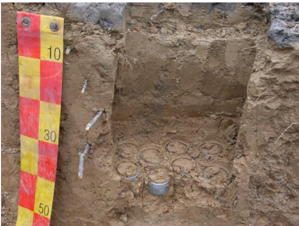
Abb. 3: Durchführung der Stechzylinderbeprobung für die Porenraumverteilung (pF-Wert).
