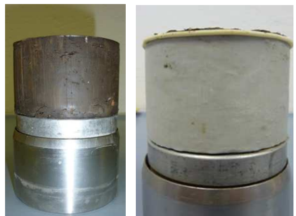
Abb. 1: Tonprobe mit Gummimembran
