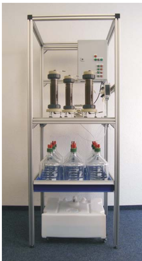
Abbildung 1: Automatische Säulenperkolationsanlage (ecoTech GmbH)
