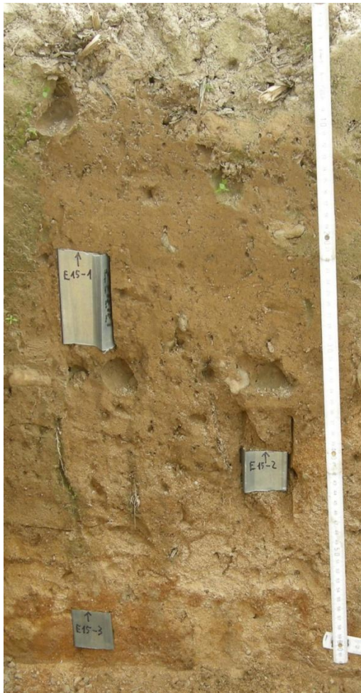
Abb. 5: Referenzprofil, Braunerde aus Kolluvium über Schmelzwassersanden. Lediglich im Pflughorizont überwiegt schluffiges Material. Im Bv und Bbt+ICv-Horizont dominieren Sande die Korngrößenverteilung.
