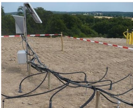
Abb. 3: Datenlogger DL-200 mit dazugehörigen TDR- und FDR-Sonden
